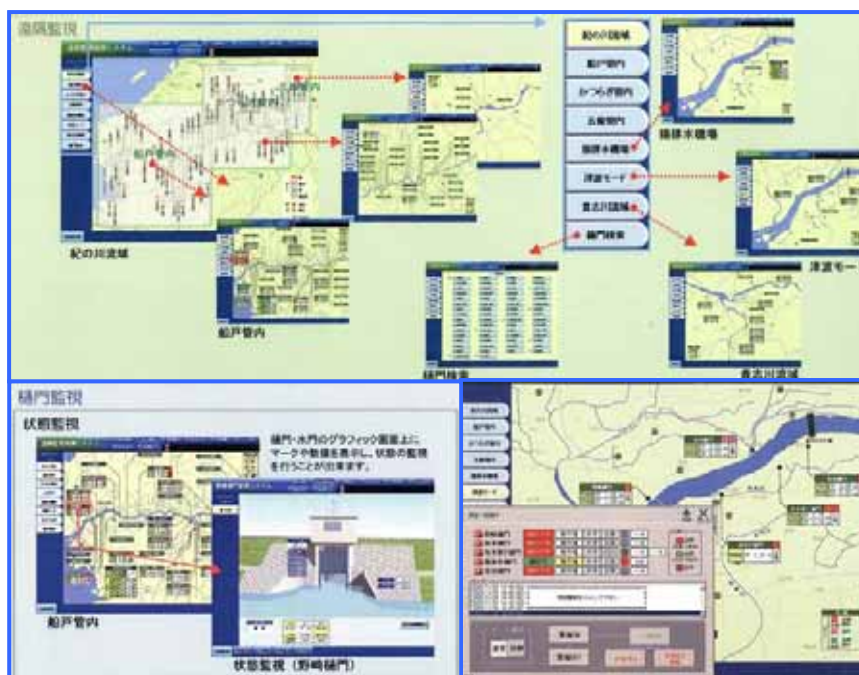
図 4.4.1 運転支援システム（樋門監視と遠隔操作）
