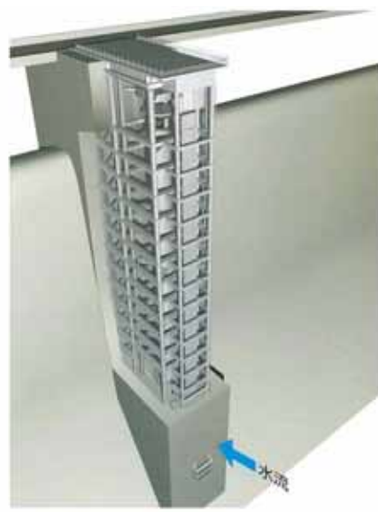
図 2.4.7 大滝ダム-選択取水設備
