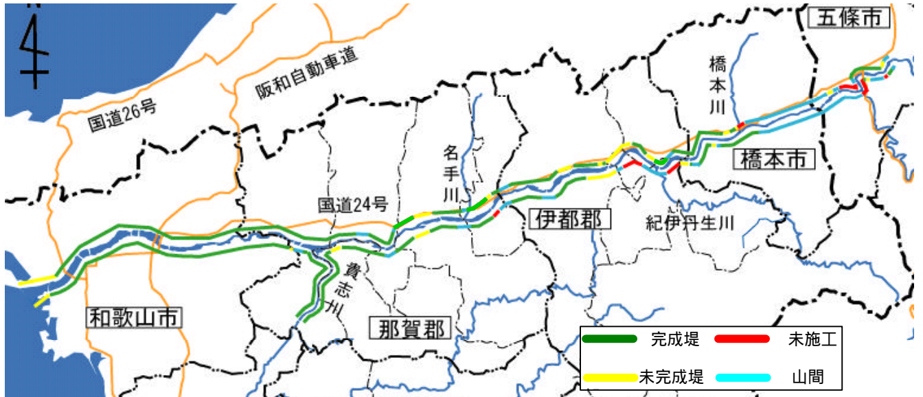
図2.1.1 堤防整備状況図(平成15年3月)
