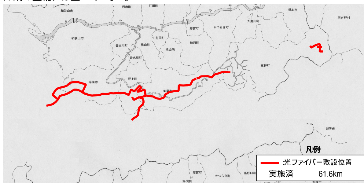
図2.1.5 光ファイバーの設置状況
