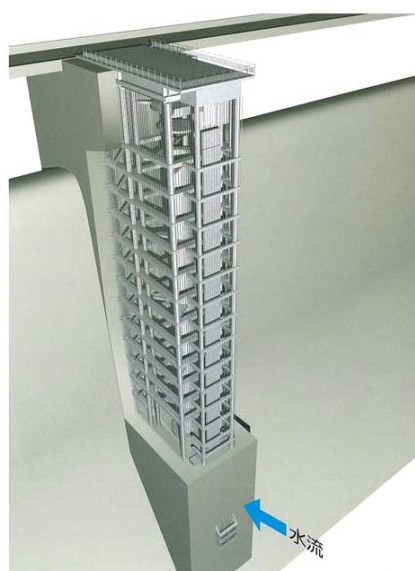
図 2.4.7 大滝ダム-選択取水設備
