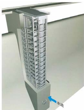
図2.4.12 大滝ダム-選択取水設備
