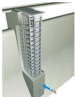
図2.4.12 大滝ダム-選択取水設備
