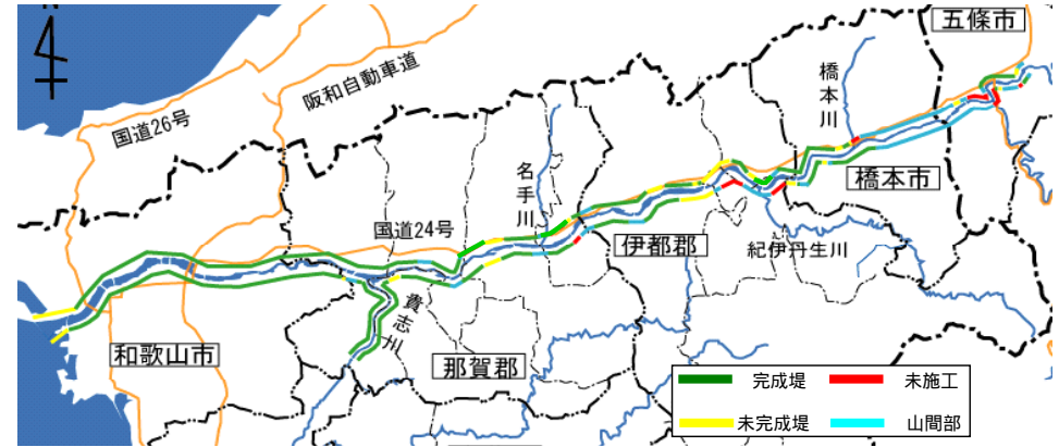
図2.1.1 堤防整備状況図(平成15年3月)
