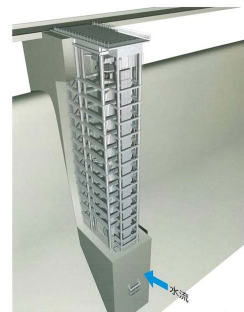
図2.4.12 大滝ダム-選択取水設備
