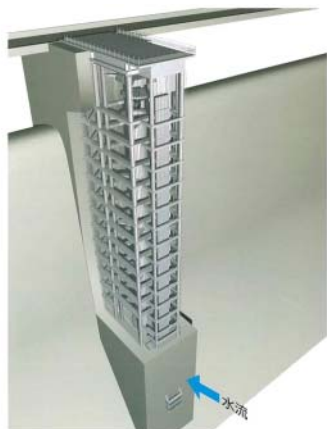
図2.4.12 大滝ダム-選択取水設備
