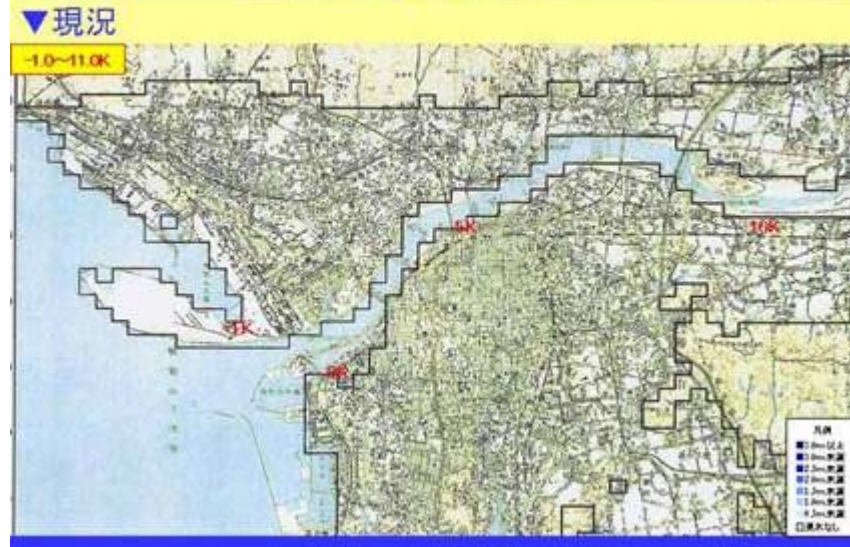
昭和34年9月型洪水(計画雨量313mm) における氾濫軽減効果(1) 大滝ダム 2500m 3 /s一定放流
