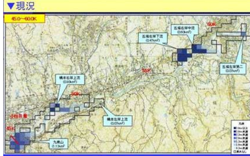
昭和34年9月型洪水(計画雨量313mm) における氾濫軽減効果(4) 大滝ダム 2500m 3 /s一定放流
