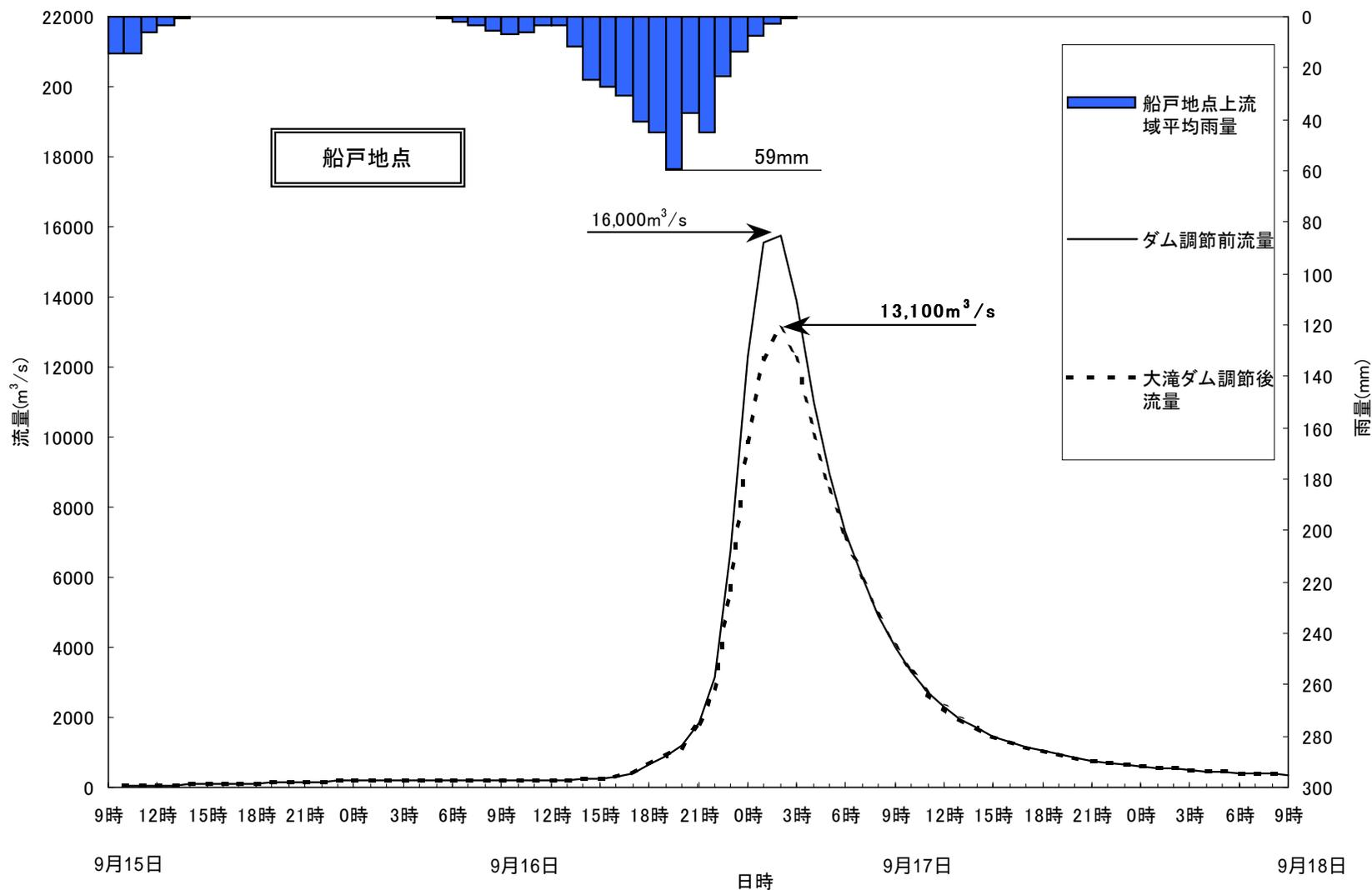
※洪水調節方法1,800m<sup>3</sup>/s洪水調節開始、放流率0.25の一定率一定放流(最大放流量2,700m<sup>3</sup>/s)
