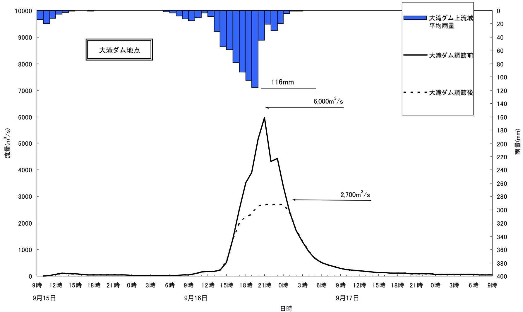
※洪水調節方法1,800m<sup>3</sup>/s洪水調節開始、放流率0.25の一定率一定放流(最大放流量2,700m<sup>3</sup>/s)
