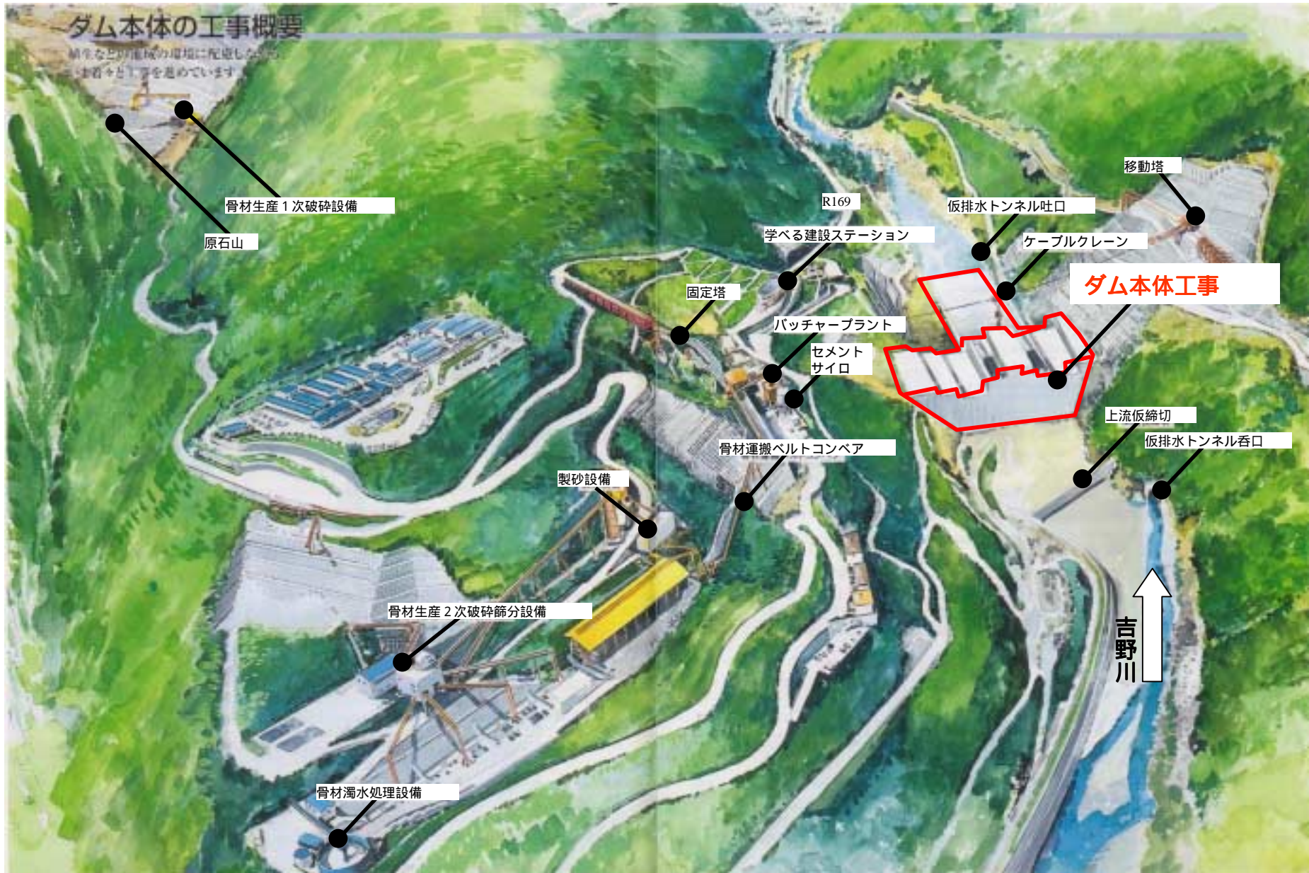
図11 ダム本体工事の概要
