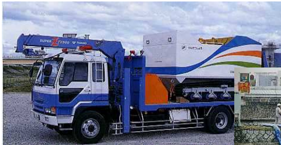
排水ポンプ車
