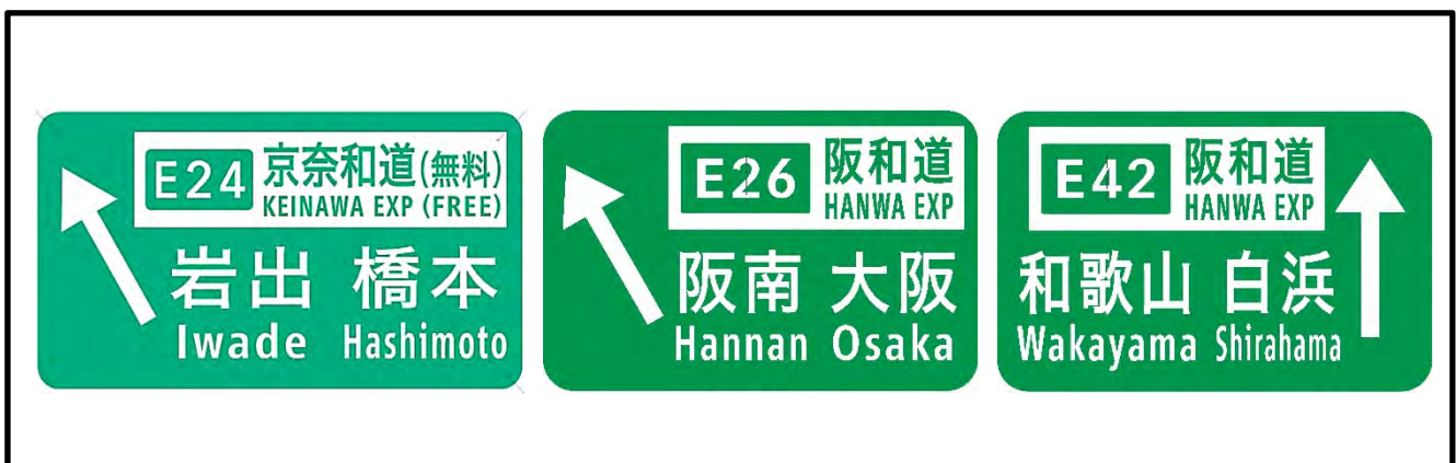
今回の開通に併せて設置する高速道路ナンバリング標識
