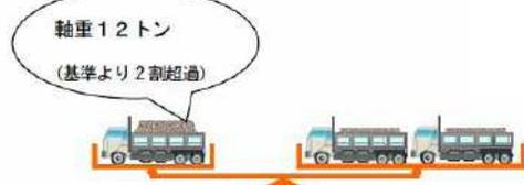
例えば、大型車両1台が軸重10トンの基準よりも2トン超過した場合、舗装に対しては約2台分の加重が蓄積され、道路が損傷する原因になります。
