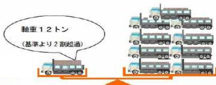
例えば、大型車両1台が軸重10トンの基準よりも2トン超過した場合、橋梁に対しては約9台分の加重が蓄積され、道路が損傷する原因になります。
