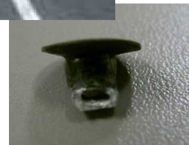
破断したブラインドリベット
