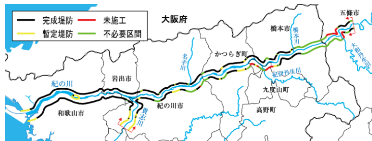
▲ 堤防整備状況図(平成23年3月時点)
