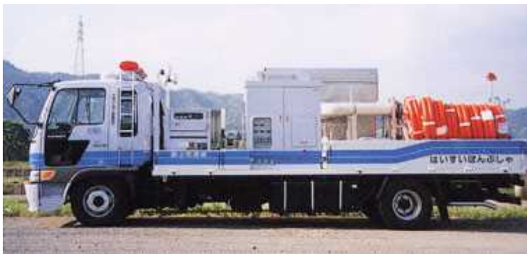
排水ポンプ車
