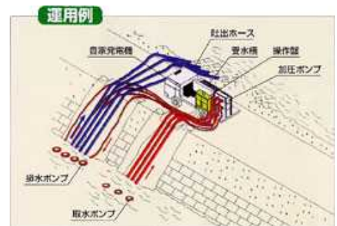
排水ポンプ車 運用例
