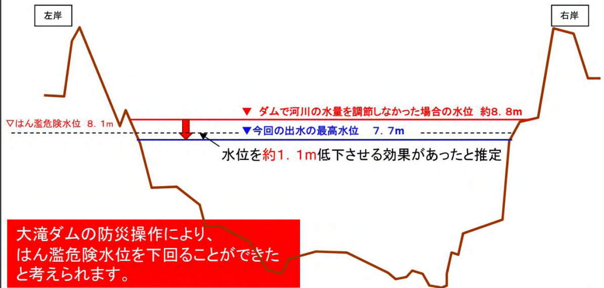
五條地点 (大滝ダムより下流40km地点)における紀の川の水位低下効果
