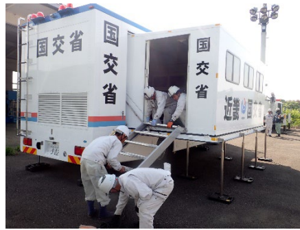
拡幅作業を行っています。(打合せスペース:7畳→最大13畳)
