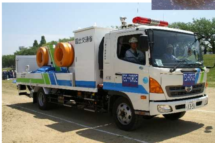
排水ポンプ車
