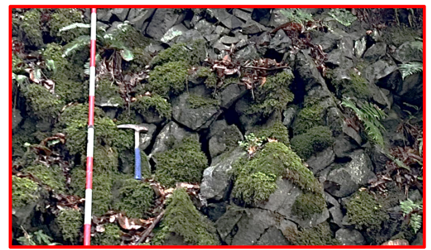
露岩拡大 一部は割れ目が開口し、石積み状となる(岩盤のゆるみ)
