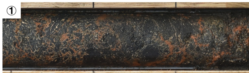
① 玄武洞玄武岩(自破碎状溶岩):GL-9.20~9.50m
