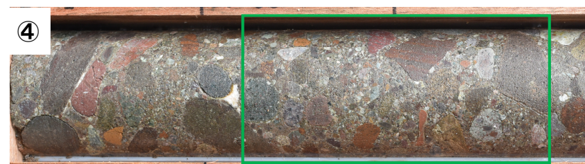
④ 北但層群(円礫岩):GL-60.00~60.30m [一軸圧縮強度:14.5MN/m 2 、密度:2.470g/cm 3 、P波速度:3.17km/sec]
