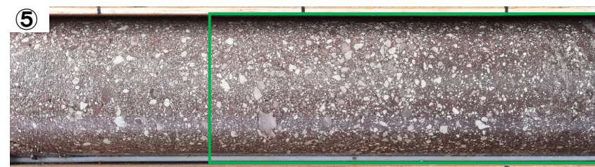
⑤ 北但層群(火山礫凝灰岩):GL-104.35~104.65m [一軸圧縮強度:160.0MN/m 2 、密度:2.622g/cm 3 、P波速度:4.92km/sec]
