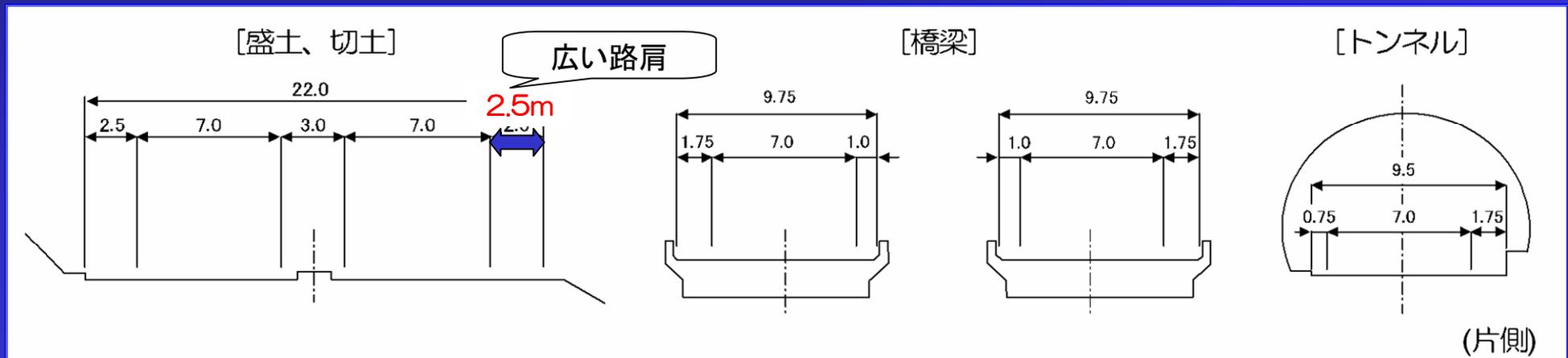
※ 土工区間（盛土、切土）は、一次堆雪幅を確保し、冬期堆雪時でも安全な交通を確保可能な全路肩(2.5m)としている。
