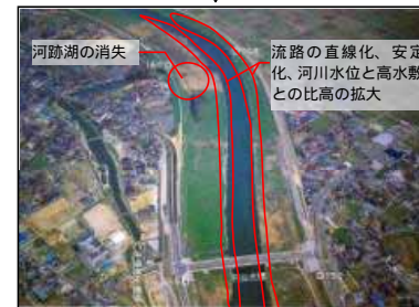
この区間は流路の直線化、安定化などにより一様な横断形状となり、河川水位と高水敷高との比高が拡大している。
