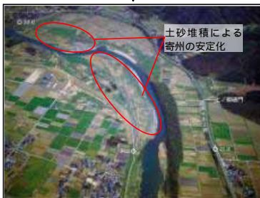
土砂堆積等により寄州が安定化し、河岸の湿地環境及び礫河原が減少している。
