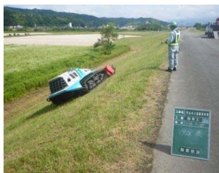
遠隔操縦式除草状況
