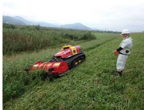
遠隔操作式除草状況
