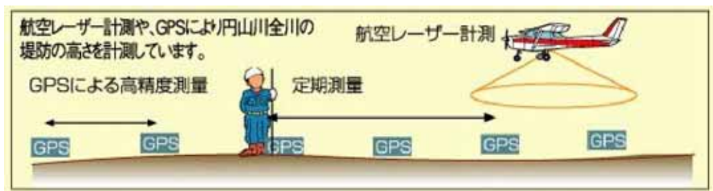
図 4.5 航空計測やGPSを用いた堤防管理
