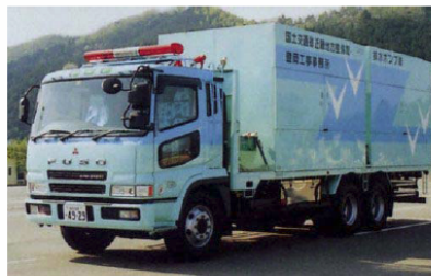
図 4.4.4 排水ポンプ車
