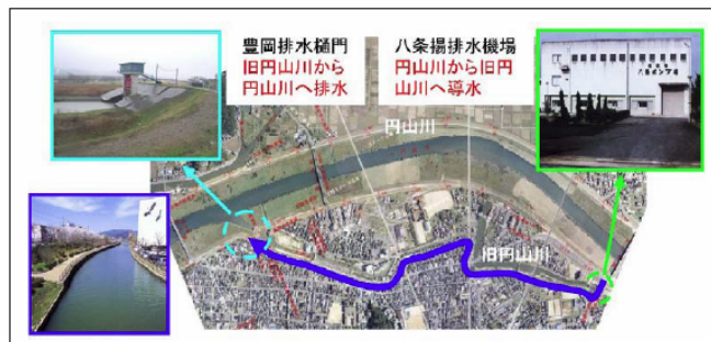
図 4.3.11 旧円山川（戸牧川）における浄化水の導入
