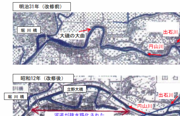
図 1.2.3 大正～昭和初期の改修（大磯の大曲のショートカット）
