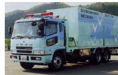
図 4.4.4 排水ポンプ車
