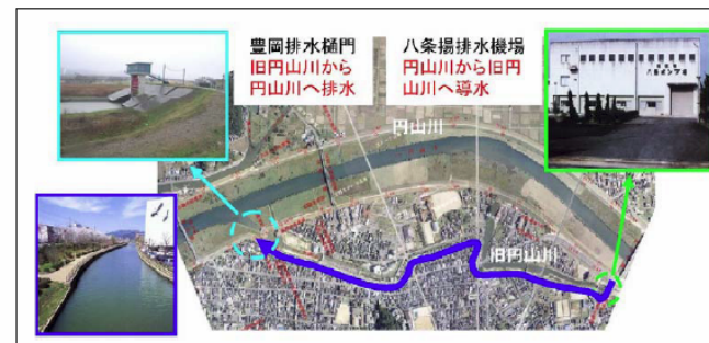
図 4.3.12 旧円山川（戸牧川）における浄化水の導入
