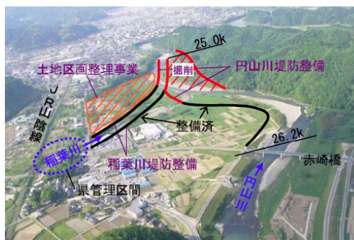
図 4.1.3 稲葉川合流部無堤対策の概要図
