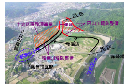
図 4.1.4 稲葉川合流部無堤対策の概要図
