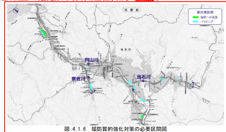
図 4.1.6 堤防質的強化対策の必要区間図
