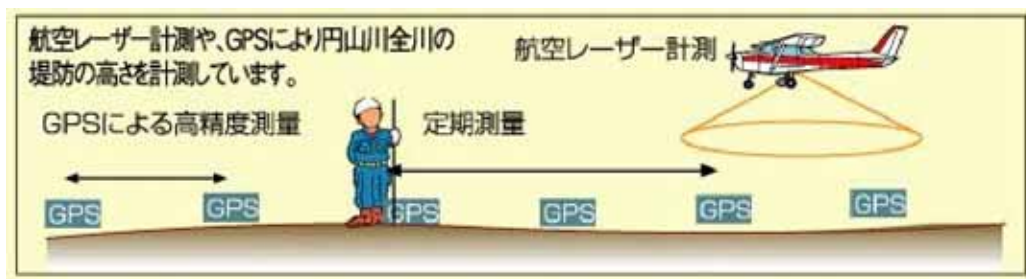
図 4.4 航空計測や GPS を用いた堤防管理
