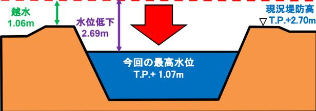
戸牧川横断図(A-A'断面模式図)
