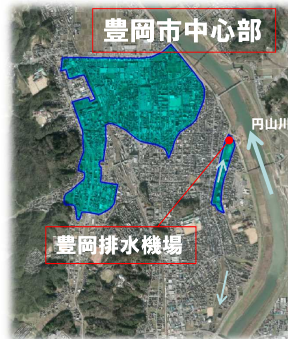
▲豊岡排水機場が稼働しなかった場合の浸水範囲
