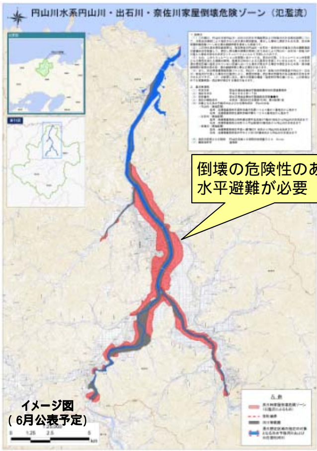
家屋倒壊危険区域
