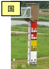
量水標(立野水位観測所)
