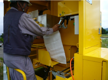
土のうに土砂投入
