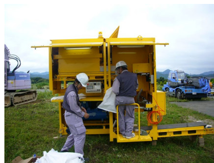
土のうに土砂投入
