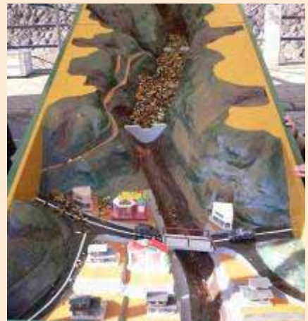
土石流模型実験装置：砂防えん堤ありの様子
