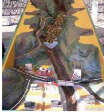
砂防えん堤ありのようす
