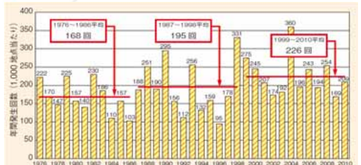
1時間降水量50mm以上の年間発生回数(1,000地点当たり) (参考:気象庁資料)
