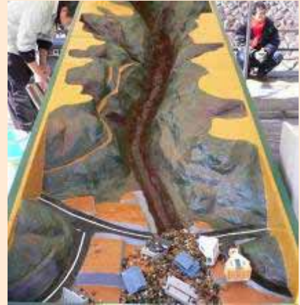
土石流模型実験装置：砂防えん堤なしの様子
