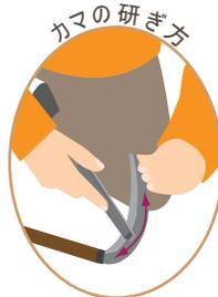
カマの柄を足で踏んで、刃を固定させます。刃の曲線に合わせて、指を切らないように砥石を左右に動かします。
