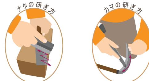
ナタを安定した岩や切り株の上に固定し、刃の角度に砥石を合わせて、刃に対して垂直方向に動かしながら左右に移動させます。
