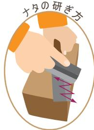
ナタを安定した岩や切り株の上に固定し、刃の角度に砥石を合わせて、刃に対して垂直方向に動かしながら左右に移動させます。
