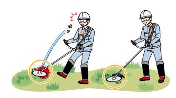
飛散物防護力バーを装着し、安全に作業しましょう。
