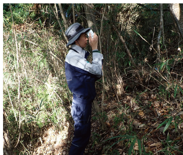
立地条件調査:クリノメーターで斜面の傾斜と方位を測定
