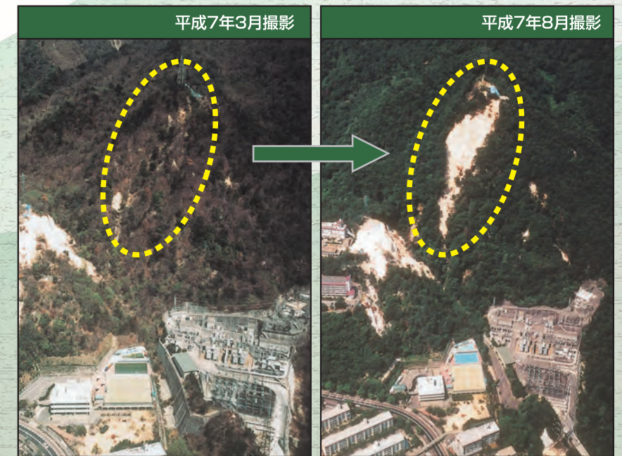
地震後の降雨により発生した鶴甲団地上流の新たな山腹崩壊
