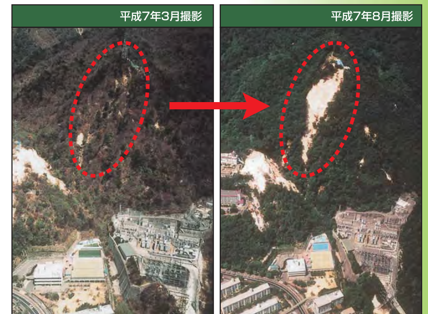
地震後の降雨により発生した鶴甲団地上流の新たな山腹崩壊
