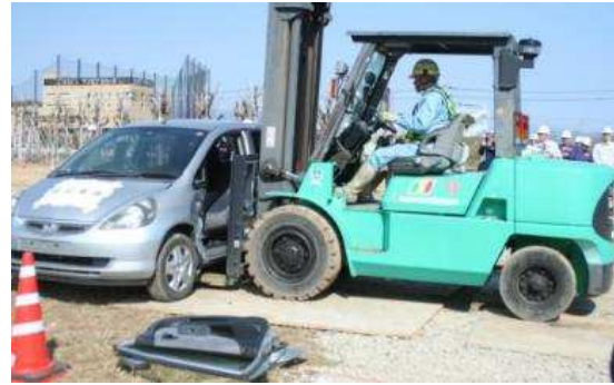
図 路上車両の撤去イメージ
