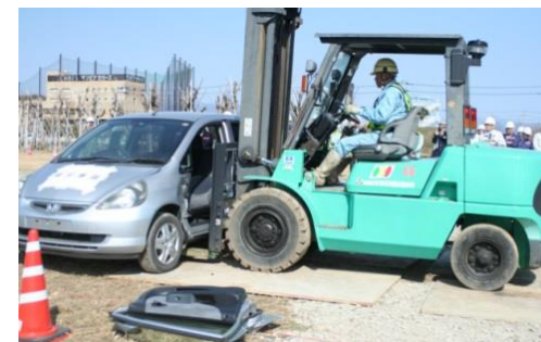
図 路上車両の撤去イメージ
