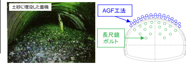
<周辺トンネルでの事故事例(切羽崩壊)> <複数補助工法の組み合わせ事例>
