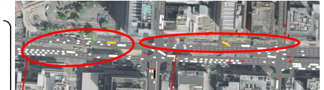
路上バス停の阻害がなくなり、交通流が円滑化 デッキ整備による歩車分離で、交通流が円滑化 出典：国土地理院ホームページ 電子国土web地理院地図(2007年)
