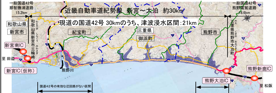
図5 津波浸水区域を通過する国道42号
