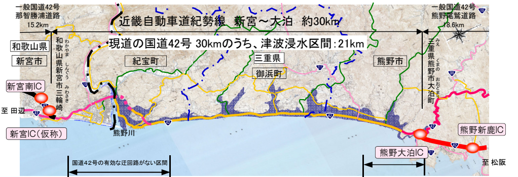
図5 津波浸水区域を通過する国道42号
