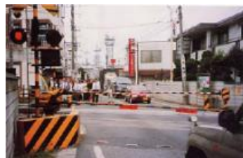
遮断機・警報機
