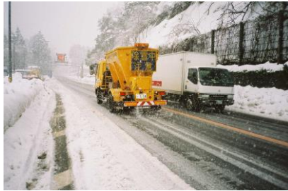
凍結防止材の散布作業
