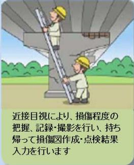
近接目視により、損傷程度の把握、記録・撮影を行い、持ち帰って損傷図作成・点検結果入力を行います
