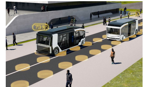
大阪・関西万博で実装が予定される 走行中給電システム
